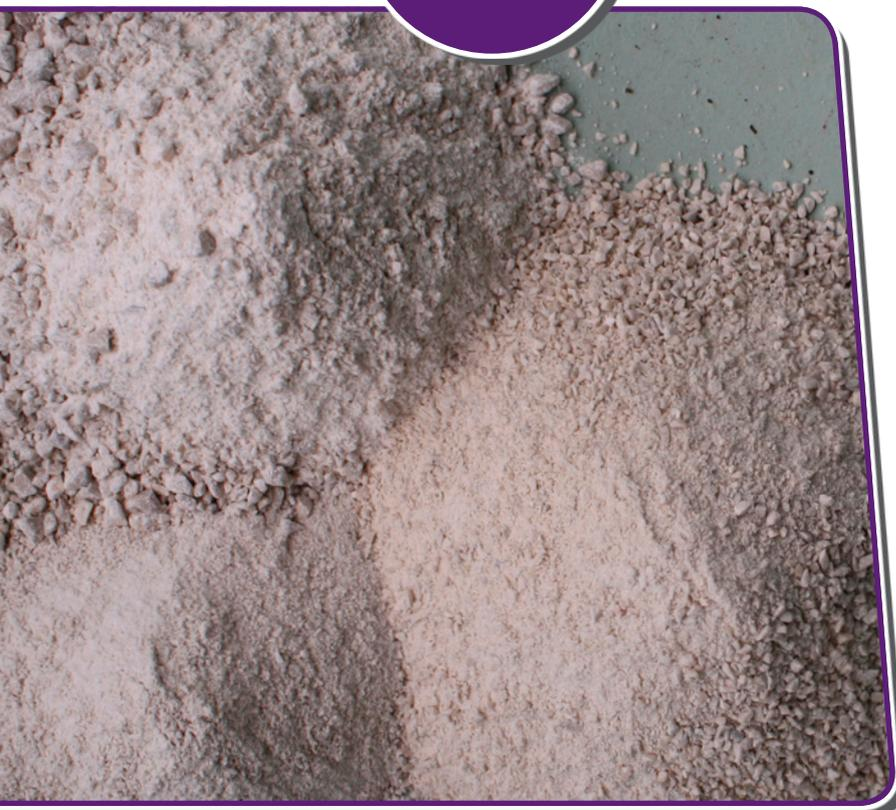
Körnungen zur Herstellung von Putz und Mauermörtel – absolut frei von organischen Verunreinigungen – beste Verarbeitbarkeit durch optimale Sieblinien – selektierte Gesteinsarten für eine perfekte Verbindung mit Sumpfkalk
